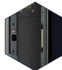
Съемная морозостойкая батарея 26,6 Втч, горячая замена, магнитная зарядка. В версии ARM: QuickCharge 3.0 - быстрая полная зарядка за 4 часа
