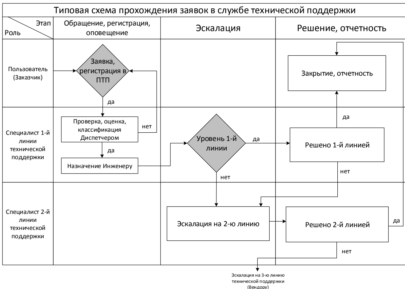
Рисунок 2. Типовая схема прохождения обращений в службе технической поддержки и работы 1-й и 2-й линий технической поддержки
